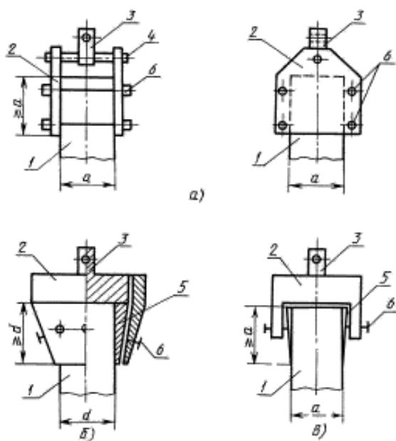
1 — образец; 2 — захват; 3 — концевой элемент шарнира Гука; 4 — ось; 5 — цанг; 6 — стягивающие винты
