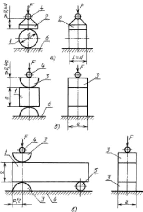
1 — образец; 2 — нагруженное устройство (плита) при испытании цилиндра; 3 — нагруженное устройство (колющий стержень) при испытании куба, призмы; 4 — шаровой шарнир; 5 — дополнительная шаровая опора; 6 — нижняя опора типа пресса (испытательной машины)
