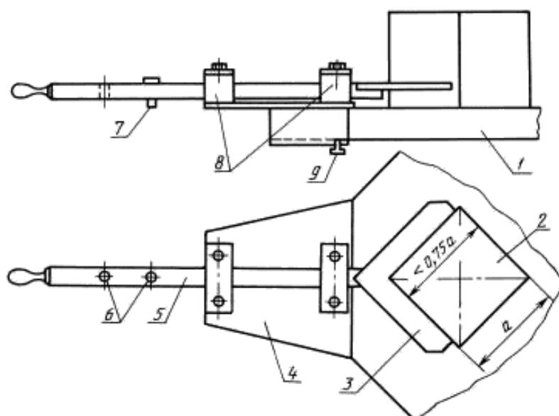
1 — плита пресса; 2 — бетонный образец; 3 — уголник; 4 — основание приспособления; 5 — шток;
