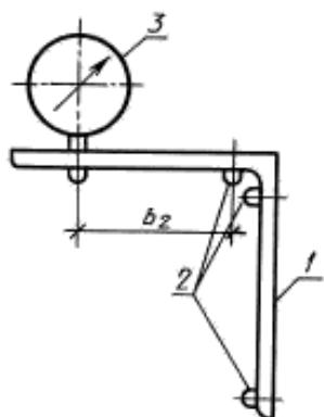
1 — корпус (угольник); 2 — опора;
