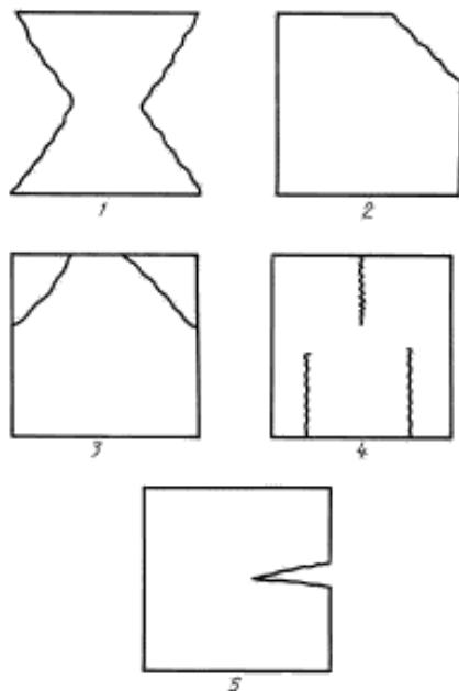
1 — нормальное разрушение; 2, 3, 4, 5 — дефектное разрушение
