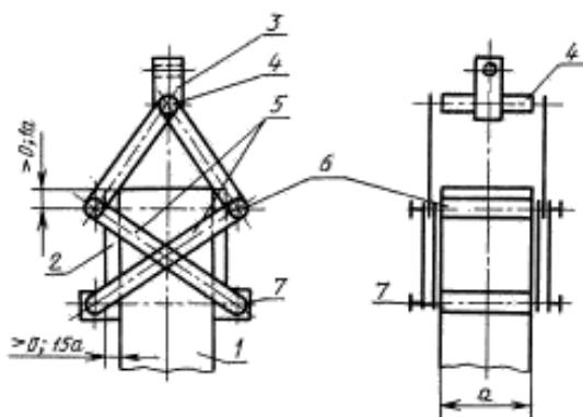
1 — образец; 2 — прижимная пластина; 3 — концевой элемент шарнира Гука; 4 — ось; 5 — тяга; 6 — подвижная опора захвата (каток); 7 — неподвижная опора захвата
