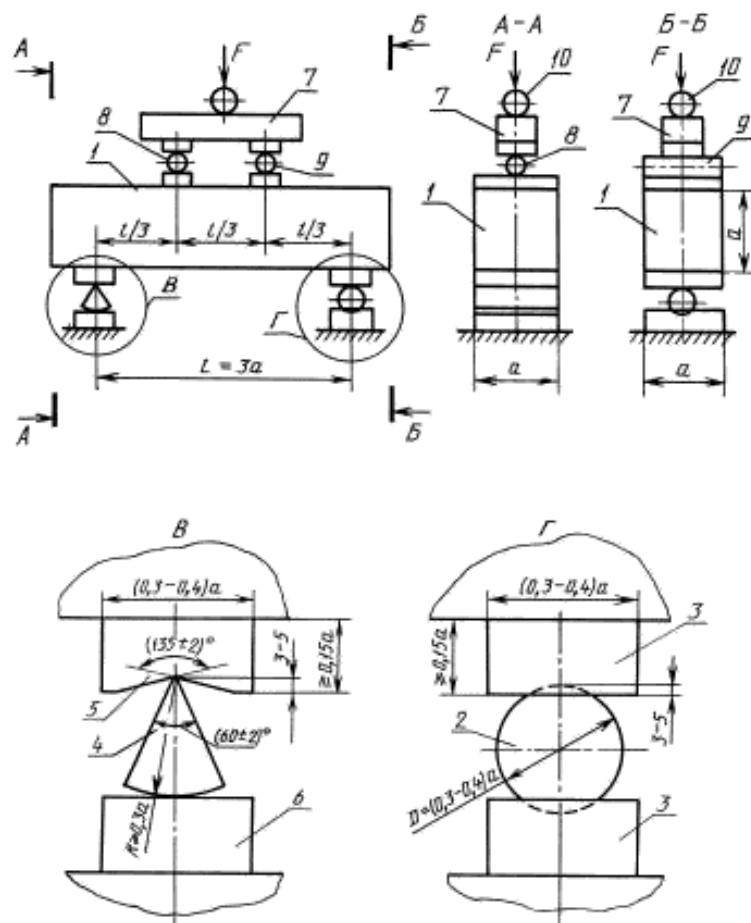
1 — образец; 2 — шар; 3 — опорная подушка; 4 — качающаяся призма; 5 — опорная сегментная подушка; 6 — опорная плоская подушка; 7 — распределительная траверса; 8 — шарнирно-неподвижная опора; 9 — шарнирно-подвижная опора; 10 — шаровой шарнир
